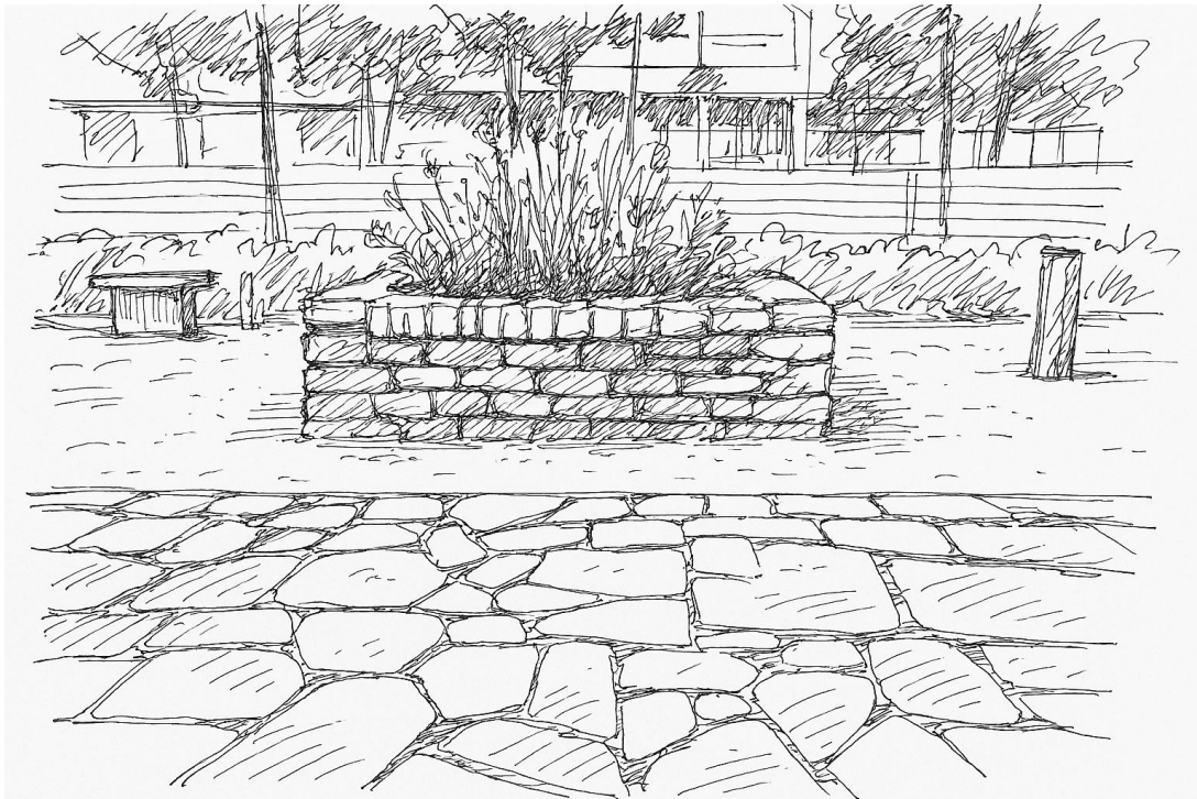
Figur 2: Illustration av återbrukade betong block från rivning (concrete rubble) för att utföra landskapselement och mark beläggningen utomhus. AI-genererad bild inspirerad av utförande i projektet "La fabrique du Clos"
