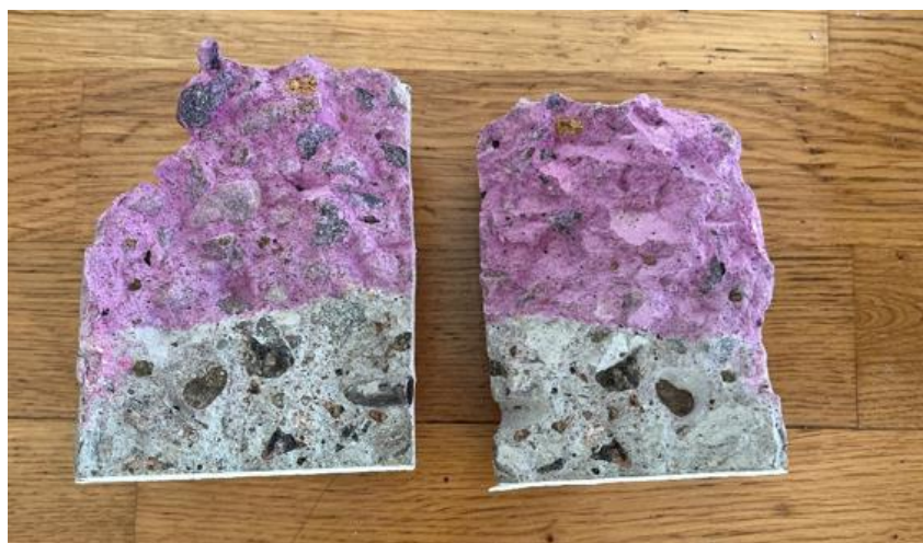
Figur 10. Karbonatiseringsprov. Den färgade delen av betongen är intakt medan den som inte färgats är karbonatiserad. På så vis kan man mäta hur långt in i betongen karbonatiseringen nått.
